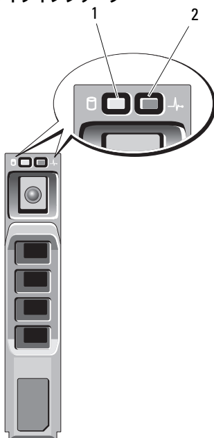
図 1-4. ハードディスクドライブインジケータ
